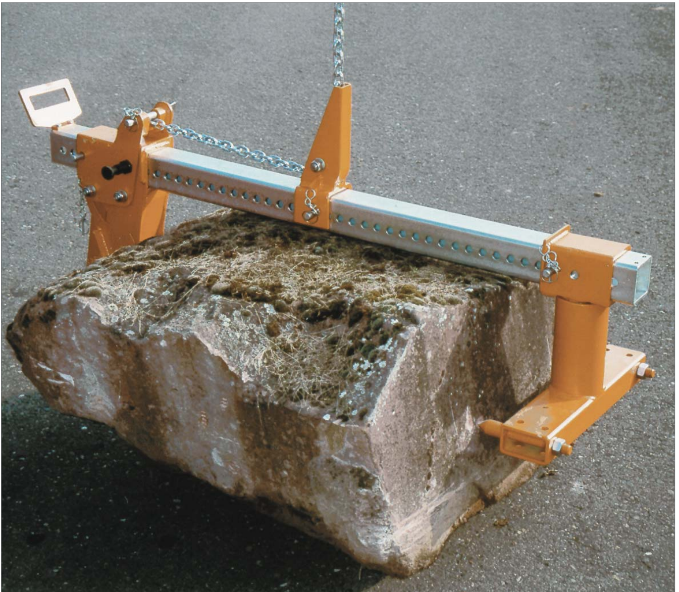
Steingreifer beim Transport von Findlingen.
