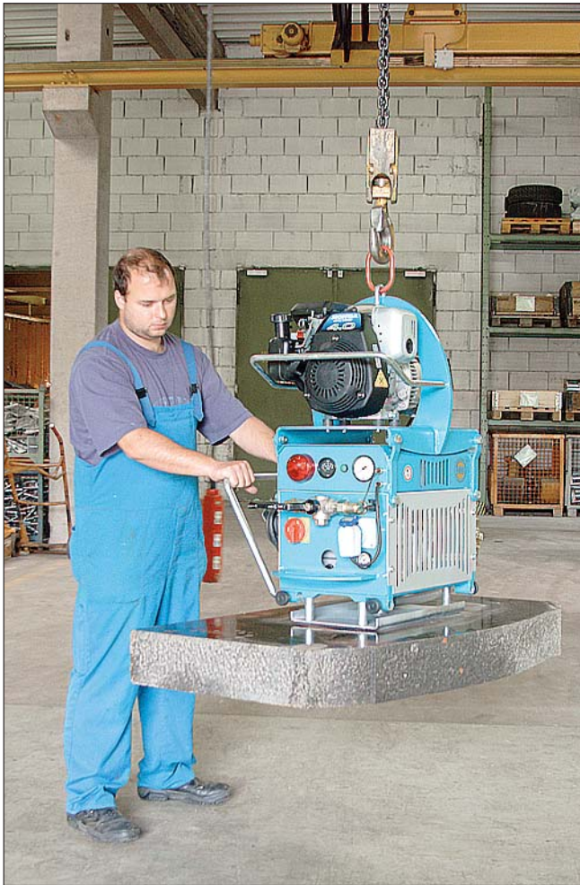
Grundgerät mit Stromerzeuger und Sicherheitspaket mit Aufhängung für Hebezeugbetrieb
