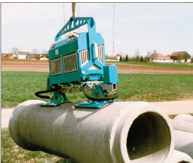
Kappa-Levator mit Verbrennungsmotor, Trägersystem mit 2 Sonder-Saugplatten für Rohre DN 500, Tragfähigkeit 1.000 kg.
