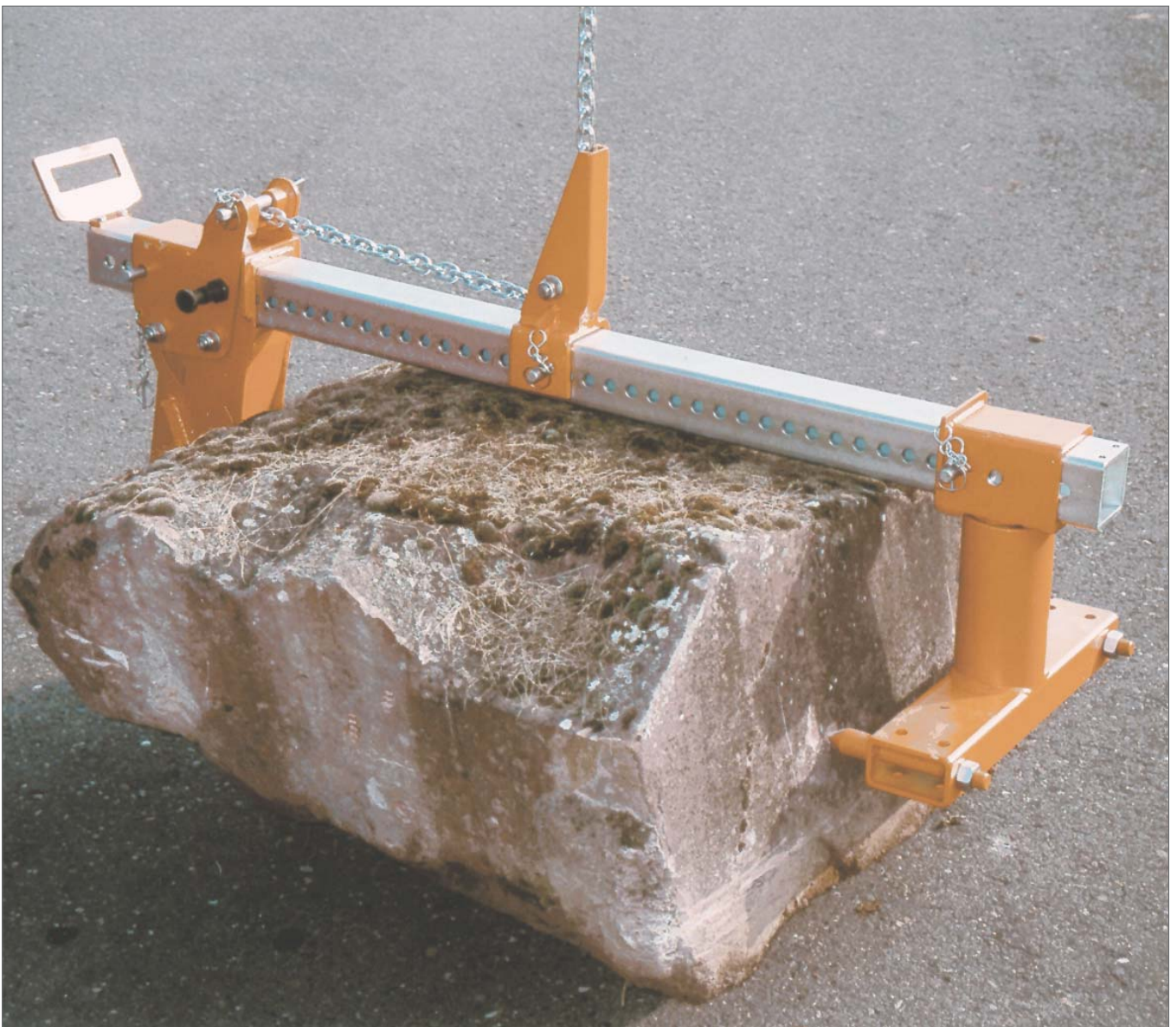
Pince pour blocs de pierre pour le transport de blocs de forme irrégulière
