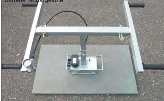
Illustr. 2 – Appareil de base avec potence biporteur et batterie rechargeable
