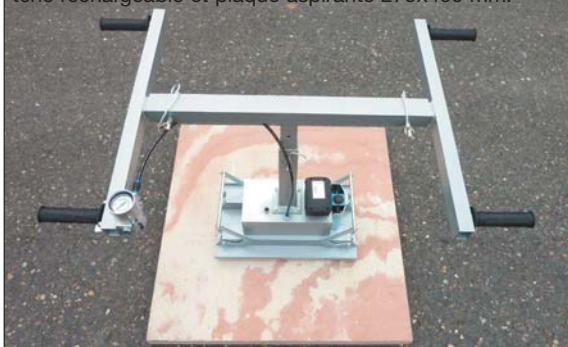
Illustr. 4 – Appareil de base avec potence biporteur, batterie rechargeable et plaque aspirante 275x460 mm.
