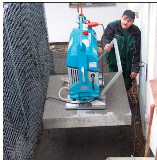
Kappa Levator avec moteur électrique, capacité de charge 800 kg.
