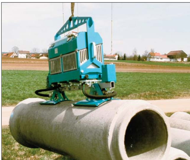
Kappa Levator avec moteur de combustion, module porteur avec 2 plaques aspirantes spéciales pour tuyaux d'un diamètre intérieur de 500 mm, capacité de charge 1.000 kg.
